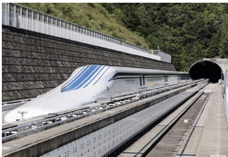
Figura 3. Tren Maglev, Chūō Shinkansen . Tren de levitación magnética con superconductores que une las ciudades japonesas de Tokyo y Nagoya (con extensión planeada a Osaka).
